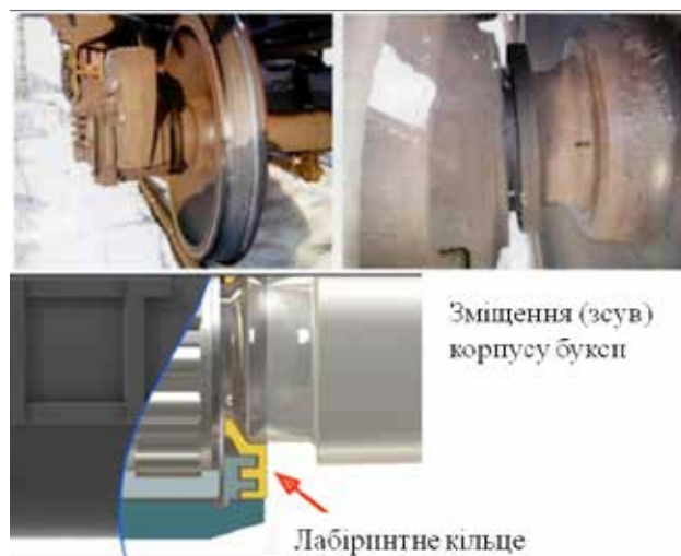
Рис. 7. Ознаки несправності буксового вузла
